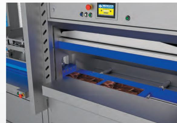
Camera di pressatura tridimensionale con area di carico utile di 1300 mm x 350 mm, composta da un pestone verticale e un pestone laterale e un pressore posteriore con funzione di formatura, massaggio ed espulsione prodotto con pressione regolabile.
