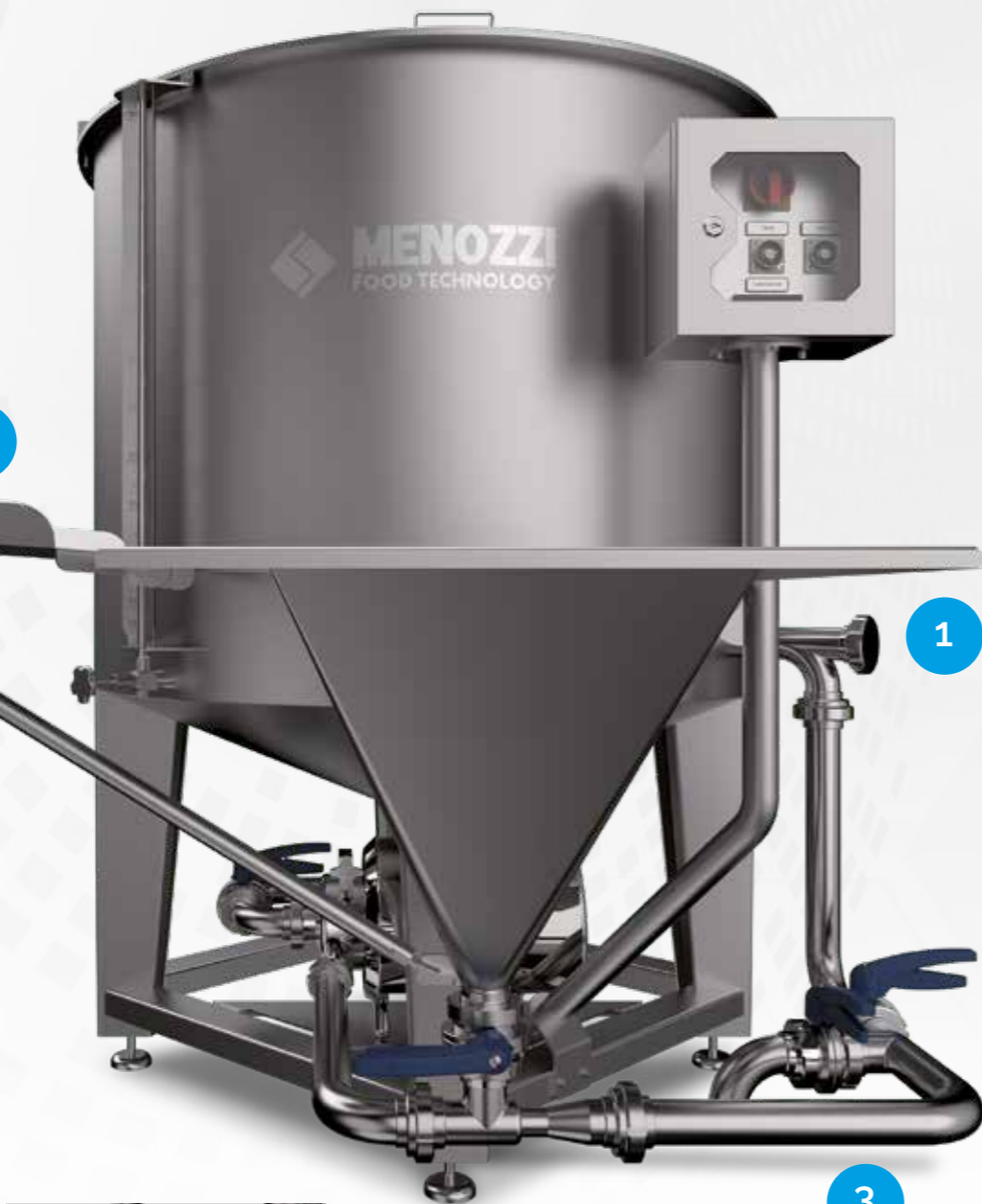
1 Massima igiene, tutti i tubi sono ispezionabili e facilmente smontabili. Costruiti in acciaio inox AISI 316 con saldature alimentari.
