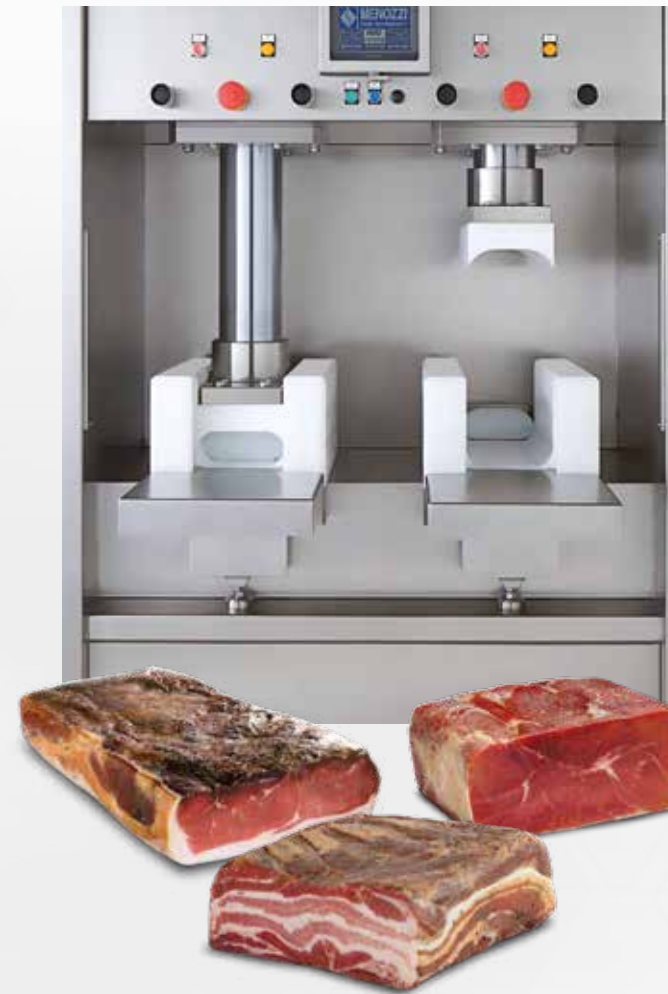
Applicazione con doppio stampo per mattonelle Application with double mold for rectangular shape
