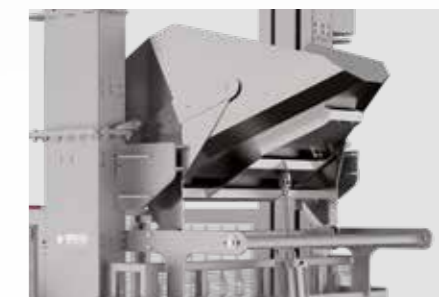
Tramoggia a ribaltamento Tilting hopper
